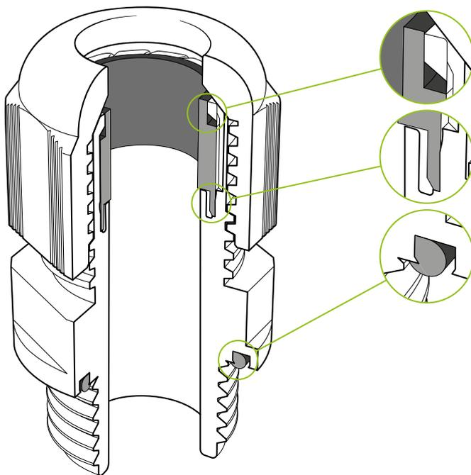
El diseño de la parte superior del cuerpo del prensaestopas retiene la junta y la mantiene en su posición.
