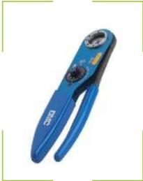
Cumple con el estándar internacional MIL-C-22520/1. El crimpado se realiza con 8 puntos de presión. La herramienta está equipada con un mecanismo de engranajes para controlar el proceso de crimpado. La herramienta debe estar equipada con un posicionador intercambiable (CCTP) según la serie de contactos a crimpar.
